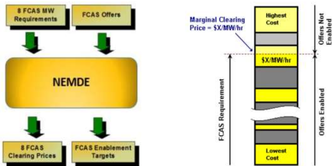
Hình 3. Minh họa tính toán và phương pháp xác định giá FCAS (nguồn AEMO)
